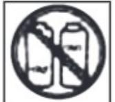
۱۲- هرگز از کپسول اکسیژن و یا دیگر گازهای اشتعال زا جهت تامین هوای ورودی دستگاه استفاده نکنید. این کار منجر به انفجار و آسیب جدی به کاربر می شود.
