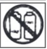
۱۲- هرگز از کپسول اکسیژن و یا دیگر گازهای اشتعال زا جهت تامین هوا و ورودی دستگاه استفاده نکنید. این کار منجر به انفجار و آسیب جدی به کاربر می شود.
